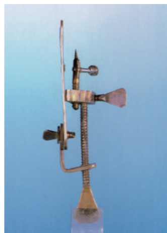
17世紀に発明されたこの顕微鏡の倍率は現在の顕微鏡の300倍に相当する。
