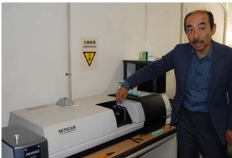
(図3) 粉体層の内部構造を3次元で見ることもできる
